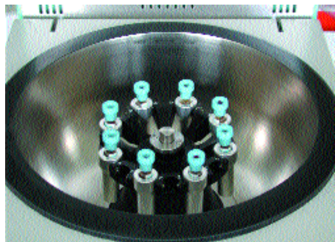
Abbildung 2 Innenansicht der Zentrifuge zur Aufnahme von 8 blauen Zitrat-Vacutainer-Röhrchen
