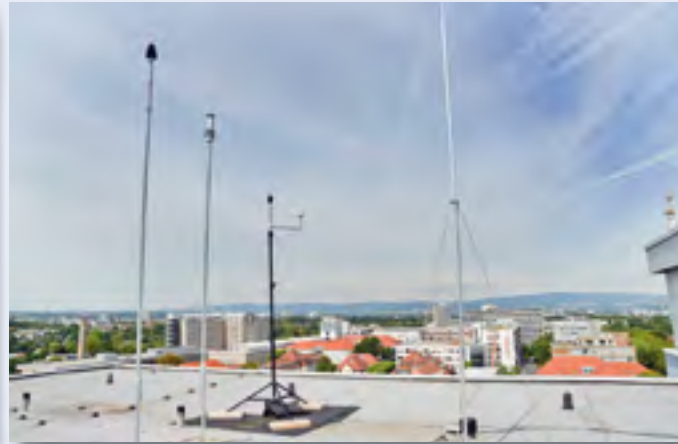
Fluglärmmessstation auf Geb. 102 der Universitätsmedizin Mainz in Höhe von 160 üNN
