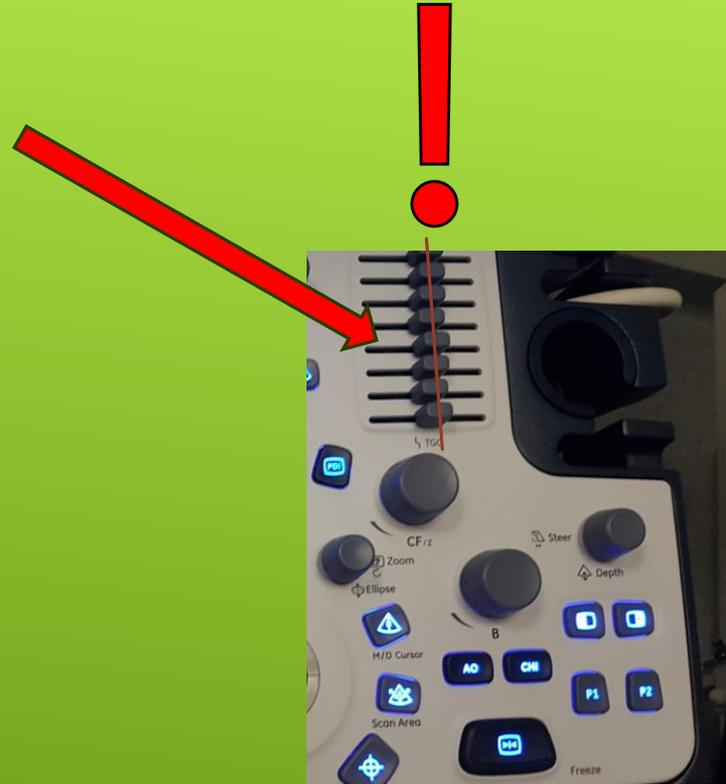
!! Anders als bei vergleichbaren Geräten, sind bei dem GE-Gerät die Schieberegler in einer Senkrechten zu positionieren!!
