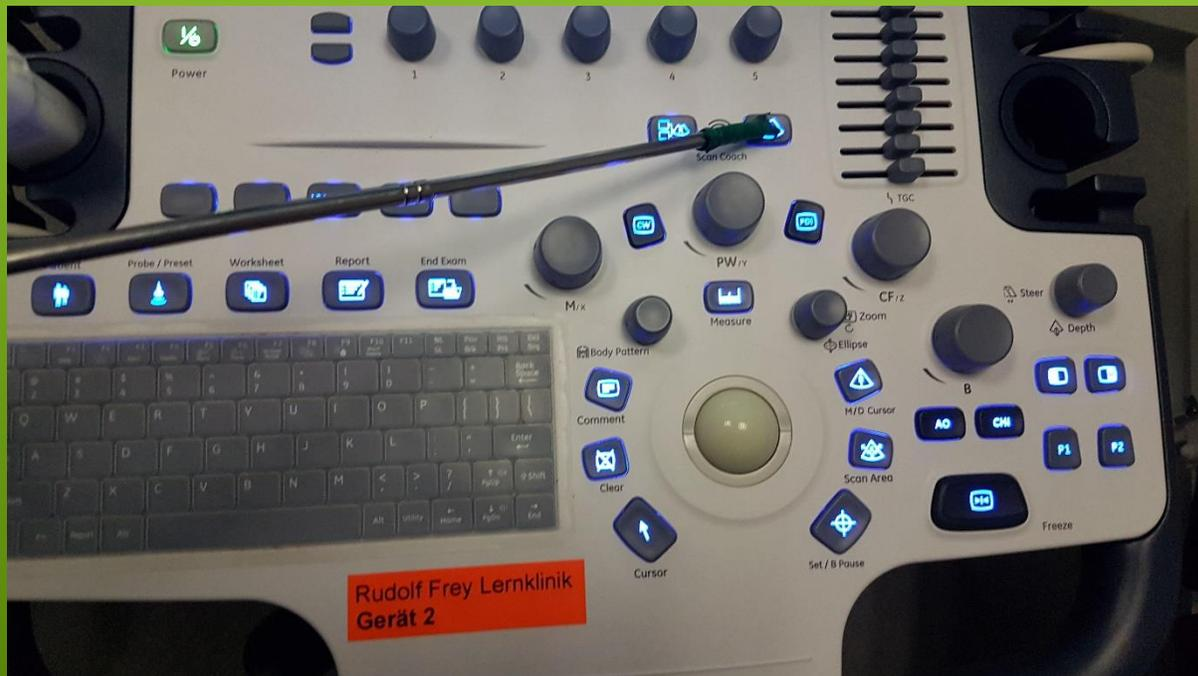
2. Die Bedienung erfolgt grundlegend wie bei einem Computer. Dabei ist der „Tracking Ball“ als „Maus-Ersatz“ und die „Set / B Pause“-Taste (im folgenden „Set“-Taste) als „linke Maustaste-Ersatz“ zu sehen. Das heißt: der „Tracking-Ball“ dient der Navigation des Cursors über den Bildschirm/Bedienoberfläche des Programmes, während die „Set“-Taste als allgemeine „Bestätigung“-Taste zu verstehen ist und damit jede Auswahl mit ihr bestätigt wird.
