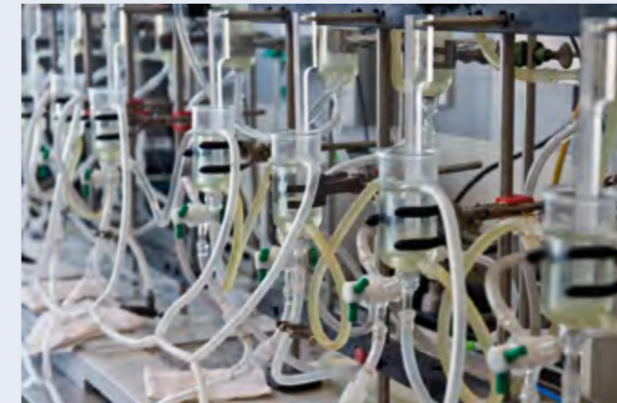
Aufbau eines Organbads zur Analyse der Gefäßreaktivität
