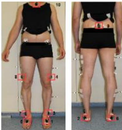
Abb. 1: Instrumentierte Versuchsperson mit 10 IMUs und dem Plug-In-Gait (lower-body) Markerset.
